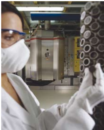
Galvanik-Entwicklungsanlage des Schaeffler Oberflächentechnikums, insbes. zur Entwicklung umweltverträglicher Korrosionsschutzschichten
