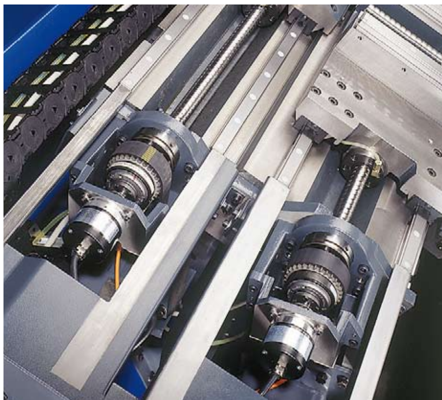
Einbaustelle: Gewindetrieblager für Kugelgewindetriebe in Vorschubachsen von Werkzeugmaschinen
